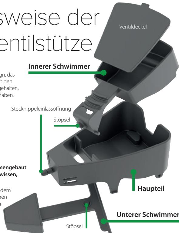
Durch die gezackte Einlassöffnung an der Vorderseite des Hauptteils fließt das Wasser aus dem 4-mm-Röhrchen in die Schale, und unter dem Ventil wieder heraus.
