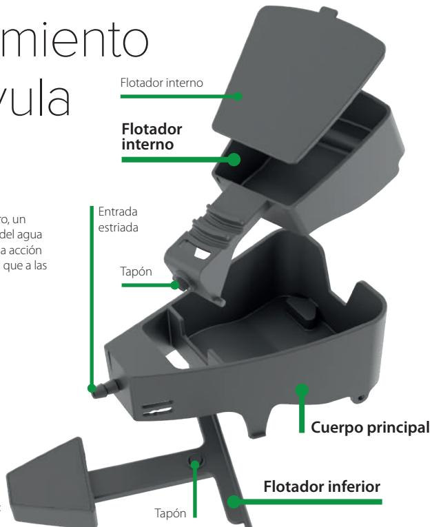
El agua entra en la bandeja desde el tubo de 4 mm, a través de la toma espigada situada en la parte delantera del cuerpo principal, y sale por debajo de la válvula.
