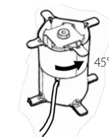
7. Sitúe la parte superior sobre la base de la columna de apoyo y gírelas 45° en sentido contrario a las agujas del reloj. Presione la bomba suavemente desde arriba con el dedo para fijar sus ventosas a la base de la columna de apoyo.
