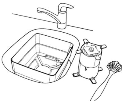
3. Spülen Sie Abdeckung, Deckel, Behälter und Stützsäule mit warmem Wasser und einem milden Desinfektionsmittel ab, um unerwünschte Bakterien abzutöten. Spülen Sie sie anschließend gründlich mit sauberem Wasser nach. Bevor Sie Ihren *Aqua Garden by PLANT!T* über einen längeren Zeitraum lagern, ist es ratsam, ihn gründlich zu reinigen. Anhaftender Schmutz und Sedimente aus der Nährstofflösung lassen sich nach dem Trocknen nur schwer entfernen!
