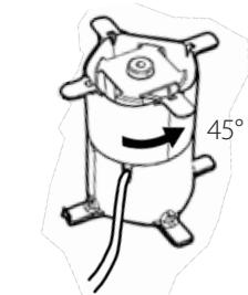
7. Positionieren Sie Ober- und Unterteil der Stützsäule aufeinander und drehen Sie sie dann um 45° gegen den Uhrzeigersinn. Drücken Sie mit dem Finger vorsichtig auf die Pumpe, um die Saugnäpfe der Pumpe am Boden der Stützsäule zu befestigen.
